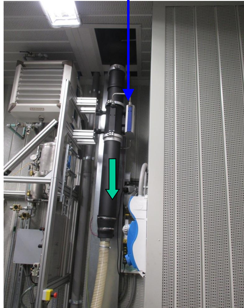
AVL Flowsonix 台架 用超声波空气流量计
